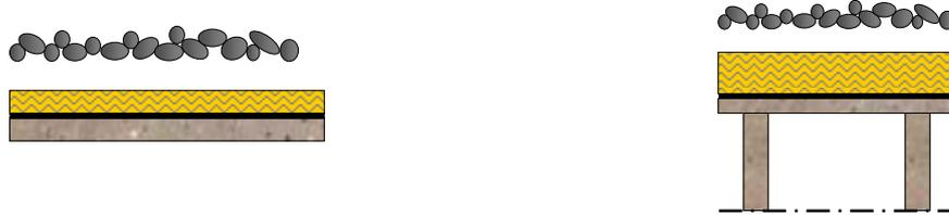
**Pour améliorer l'isolation d'une toiture inversée**, il faut éviter de rajouter une couche d'isolant à cause des risques de condensation. Il est préférable de remplacer l'isolant existant par un matériau plus performant et ou plus épais.
